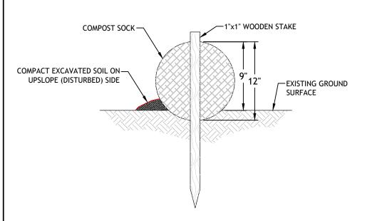
BEGIN WATTLE INSTALLATION BY EXCAVATING A 2 TO 3-INCH-DEEP BY 9" WIDE TRENCH ALONG THE CONTOUR OF THE SLOPE OR ALONG THE EXISTING GROUND SURFACE. EXCAVATED SOIL SHOULD BE PLACED UP-SLOPE OR ON THE DISTURBED SIDE OF THE ANCHOR TRENCH.
